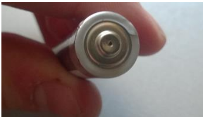
Attēls 3: Bedrītes izveidošana baterijas galā.
