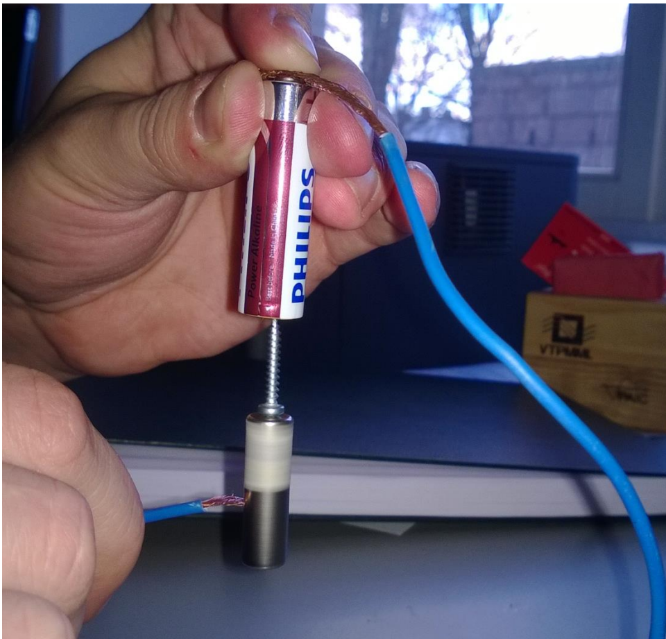
Attēls 6: Homopolārais motors ar skrūvi.
